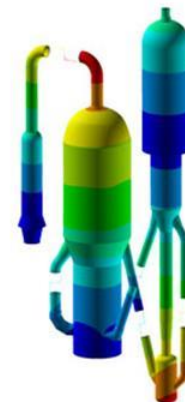
Распределение модуля вектора перемещений в расчетном режиме
