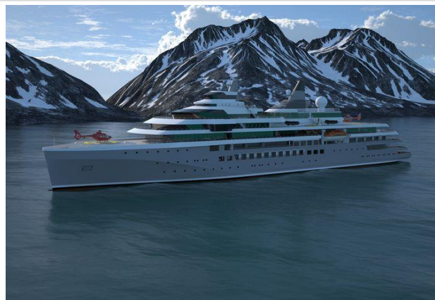
Проектное изображение экспедиционного круизного судна ледового класса PC 6 разработки Damen
