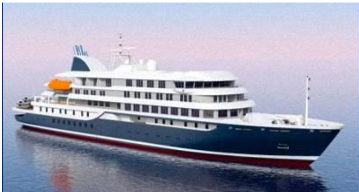
Проектное изображение экспедиционного круизного судна ледового класса PC 6 разработки Brodosplit
