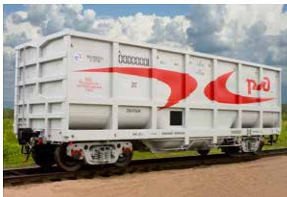
Вагон специализированный для перевозки угля и руды модели 12-9828 с осевой нагрузкой 27 тс
