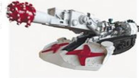
Имеет минимальную строительную высоту и давление на грунт, характеризуется большой энерговооруженностью и производительностью, и пригоден для прохождения большинства видов выработок любой формы сечения (арочной, трапециевидной, прямоугольной и круглой), может работать по пластам, содержащим каменный уголь, аргиллит и сланец с пределом прочности разрушаемых пород до 100 МПа и абразивностью до 18 мг в шахтах, опасных по газу (метану) и угольной пыли.
