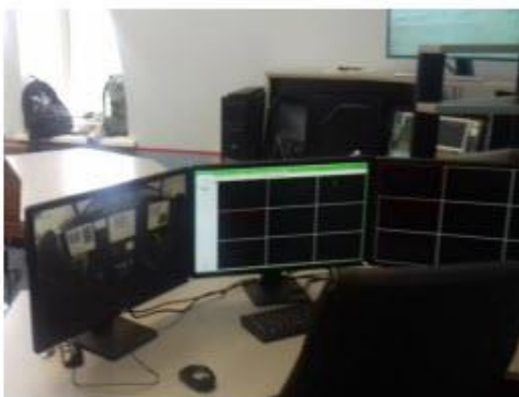
2. Рабочее место инструктора (РМИ) - для управления работой МСКБО, имитации отказов, задания метеоусловий и т.п.
