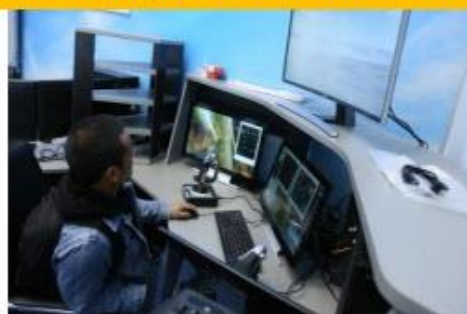
2. Рабочее место инструктора (РМИ) - для управления работой МСКБО, имитации отказов, задания метеоусловий и т.п.
