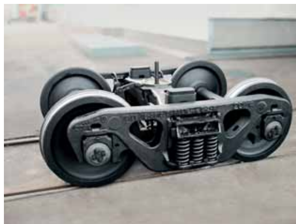
Рис. 1. Тележка модели 18-9810 типа Barber S-2-R с осевой нагрузкой 23,5 тс
