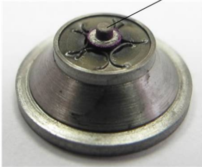
Отработанный катод (поверхностный слой насыщен парами титана)
